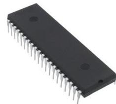
Abbildung 1, ATmega16 Mikrocontroller
